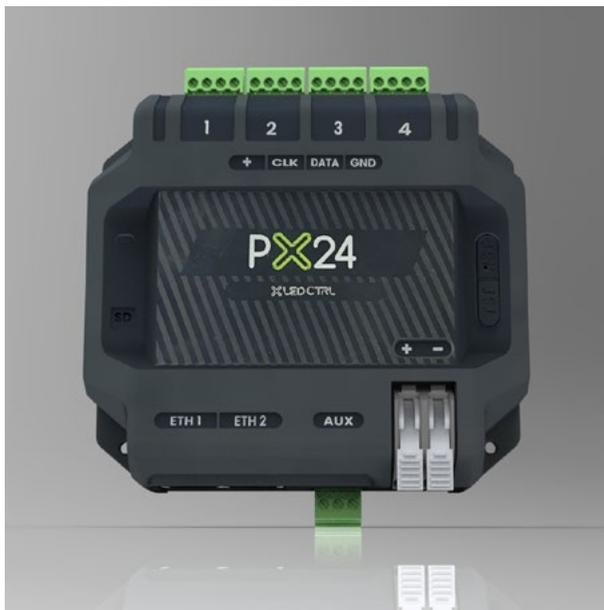
Der PX24 Pixel-LED-Controller steuert bis zu sechs Universen pro Ausgang und ermöglicht so die Kontrolle von insgesamt 24 Universen für LED-Pixel. Er verfügt über leicht zugängliche und austauschbare Schraubklemmenblöcke, die eine einfache Installation und Wartung ermöglichen. Jeder Pixel-Ausgang ist für hohe Stromlasten ausgelegt und mit einer intelligenten elektronischen Sicherung ausgestattet. Dies macht den Austausch von Sicherungen überflüssig und sorgt für einen zuverlässigen Betrieb.
