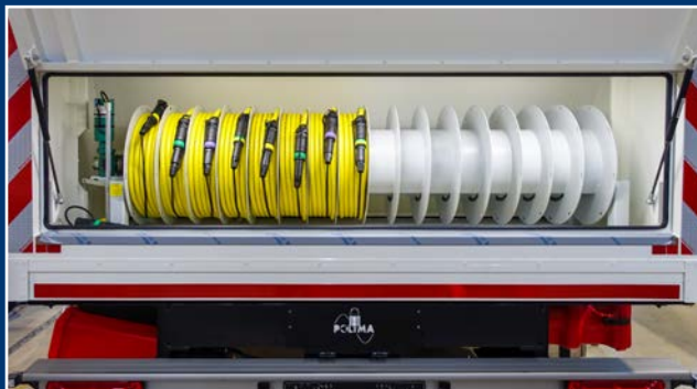
Die Leitungstrommel ist heckseitig angeordnet, sodass das Auf- und Abtrommeln ergonomisch erfolgt. Bis zu 16 Kammern sind möglich (je nach Querschnitt und Kabellänge). 24 V Getriebemotor mit Freilauf und helle LED-Beleuchtung.
