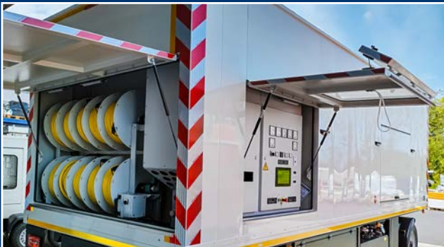
Schaltschrank, Abgangsfeld, Kabeltrommelanlage sind schalltechnisch abgeschirmt.
