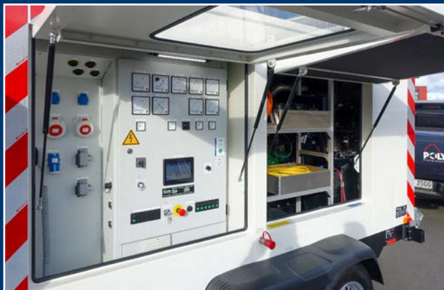
Wie bei allen POLYMA Tandemaggregaten ist der Schaltschrank bedienungssicher im Verkehrsschatten in Fahrtrichtung rechts angeordnet. Stauraum im Maschinenraum rechts.
