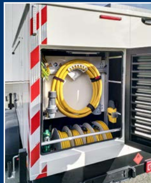
Leistungskabel an Bord, Kabeltrommel mit 24 V Antrieb, Adapterkabel, ordentlich aufgeräumt.
