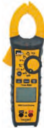
61-747 400A AC/DC Zangenmulti- meter TightSight™ mit Hintergrund- beleuchtung und Taschenlampe CAT III 600 V
